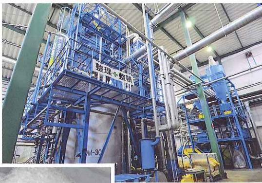
上/機械処理で選別・異物除去した後、人間の目でもチェックする 右/細かな汚れを除去する大型アルカリ洗浄装置。国内に数台しかない 下/ペットボトルから出来たフレック。これをさらに再生ペレットに加工する
