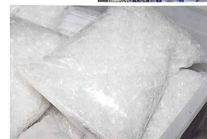
上/機械処理で選別・異物除去した後、人間の目でもチェックする 右/細かな汚れを除去する大型アルカリ洗浄装置。国内に数台しかない 下/ペットボトルから出来たフレック。これをさらに再生ペレットに加工する
