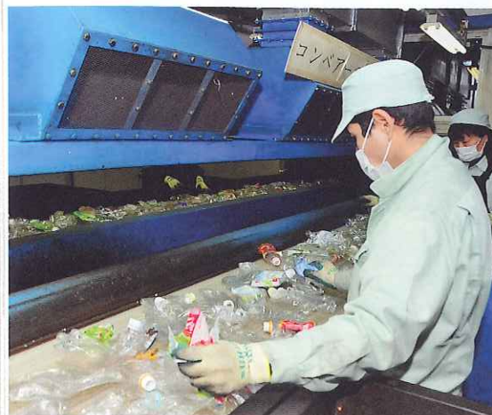
上/機械処理で選別・異物除去した後、人間の目でもチェックする 右/細かな汚れを除去する大型アルカリ洗浄装置。国内に数台しかない 下/ペットボトルから出来たフレック。これをさらに再生ペレットに加工する
