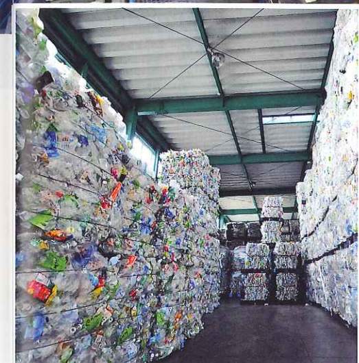
ペットボトルは圧縮減量（ペール）された状態で工場に運び込まれる。約50トンを1日で再資源化する
