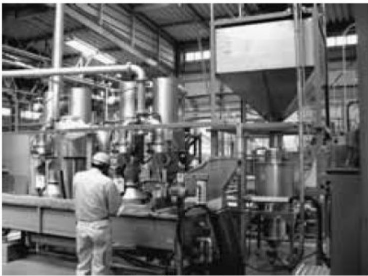
IV値を任意に制御できる押出設備を増強し安定供給体制も構築
